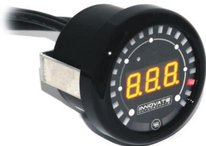
Индикатор MTX-L представляет собой измеритель соотношения воздух-кислород в выпускных газах двигателя. Работает в широком диапазоне значений соотношения от 7,35 до 22,39. Если в бензиновом двигателе это отношение определено довольно точно (14,7 для бензина), то в дизельном двигателе, работающем на бедных смесях, режим 14,7 является предельным для полного сгорания топлива. Именно эта информация и должна быть использована для настройки.
