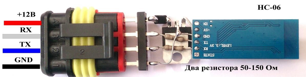
Все элементы должны быть тщательно изолированы друг от друга (на фото, для наглядности, изоляция отсутствует). Всё устройство может быть смонтировано в подходящем корпусе.
